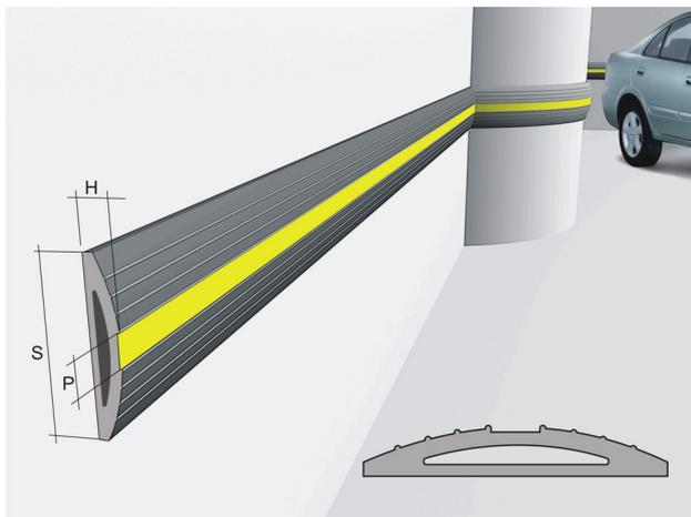
**Резиновая полоса для защиты стен** (резиновый отбойник на стену, отбойник для парковок) предназначена для защиты фасадов домов, стен парковок, пандусов, причалов, дворовых территорий, въездных ворот, тоннелей, колонн от механических повреждений при движении автотранспорта.
